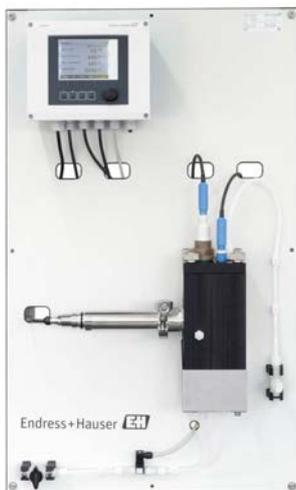
Standardpanel für die meisten Trübungsmessstellen in der Trinkwasserproduktion und -verteilung sowie für industrielles Brauchwasser. Neben der Trübung können Sie damit auch bis zu vier weitere Parameter überwachen. Zur Auswahl stehen pH, Redox, Leitfähigkeit, Sauerstoff und Desinfektion. Eine Temperaturmessung ist standardmäßig integriert.
