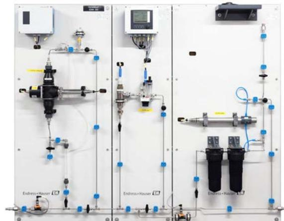
In diesem Beispiel wurden drei Panelmodule mit Edelstahlverrohrung kombiniert (links: Trübung, mittig: Leitfähigkeit und pH, rechts: SAK). Die modulare Anordnung ermöglicht eine perfekte Anpassung an Ihre individuellen Gegebenheiten, da jeder Messparameter einzeln parametrisiert und gewartet werden kann, ohne dabei die anderen Messungen zu beeinflussen.
