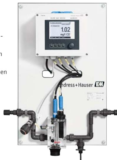
Standardpanel für die Überwachung von Desinfektionsparametern, wie z. B. freies Chlor oder Chlordioxid. Mit dem Panel können Sie die Dosierung des Desinfektionsmittels regeln. Die speziell konstruierte Armatur erlaubt den Einbau von bis zu zwei weiteren Sensoren, z. B. um zusätzlich pH, Redox, Leitfähigkeit oder Sauerstoff zu messen.
