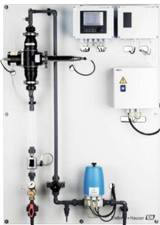
Beispiel für ein Panel mit Trübungs- und pH-Messung. Es eignet sich hervorragend für alle anspruchsvollen Applikationen im Rohwasser, Reinwasser und industriellen Brauchwasser. Dank Ultraschallreinigung, Gasblasenfalle und hoher Durchflussgeschwindigkeiten sind lange Messzyklen möglich: Sedimentpartikel, Biofilme und Luftblasen werden zuverlässig und automatisch entfernt.
