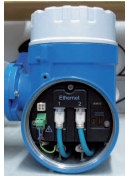
Mit Industrial Ethernet und integriertem Web-Server werden Feldgeräte von Endress+Hauser nahtlos in die IT-Welt integriert.
