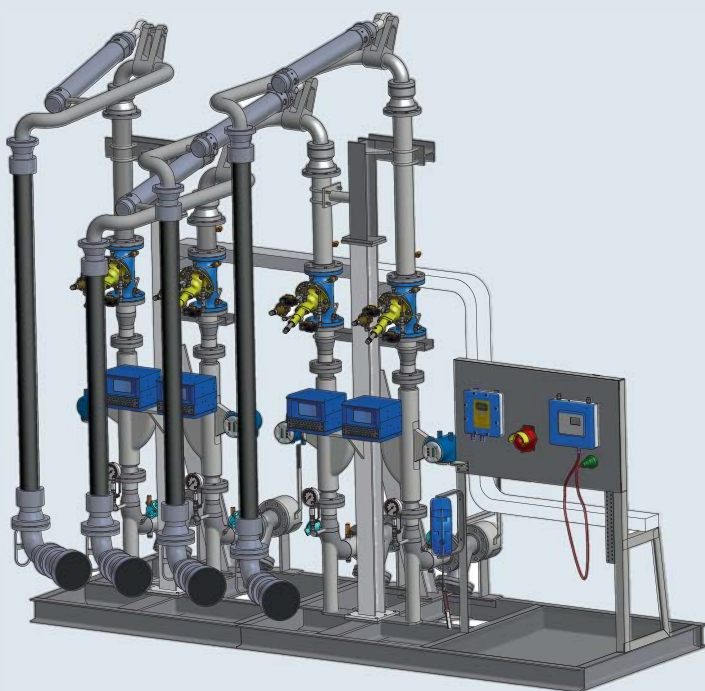
Skid vertical avec 4 bras de chargement
