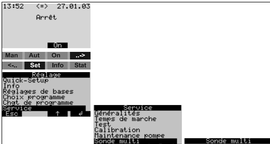
Fig. 22: Contrôle de la mesure d'oxygène (système de contrôle du capteur)
