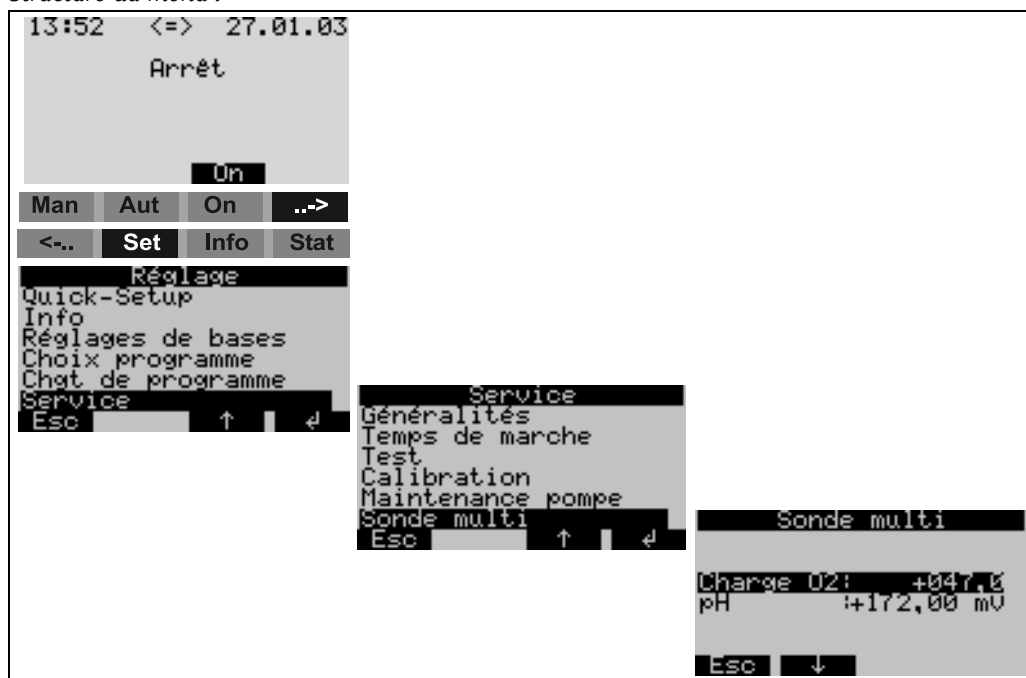
Fig. 21: Contrôle de la mesure pH (système de contrôle du capteur)
