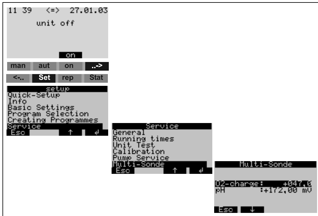
Fig. 22: Controllo della misura di ossigeno (Sistema controllo sensore)
