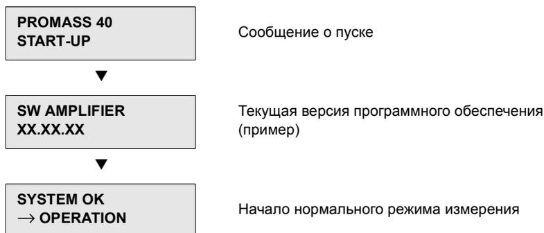
Нормальный режим измерения начинается сразу же после пуска. На экране индикатора появляются различные измеряемые величины или переменные состояния (положение HOME).
